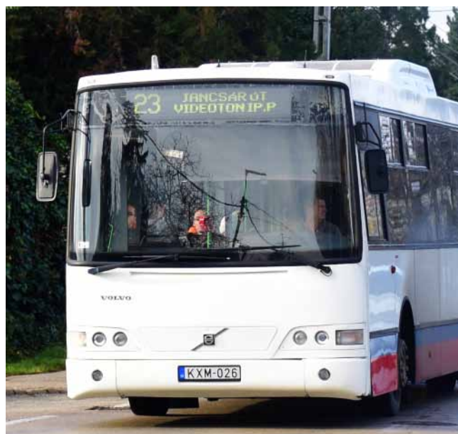
Фигура 33 Автобусите в Секесфехервар (HU) показват на предния си дисплей двете крайни станции едновременно и са непроменени по време на цялото пътуване. Неопитните потребители не знаят каква е точната посока на автобуса. Основна корекция би било да се покаже само съответното направление и да се промени в крайните станции.
