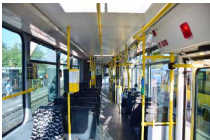
Фигура 19: Почти 40 годишен Татра трамвай в Берлин (DE) 20 години след модернизацията. Интериорът е доста чист и показва резултати от ежедневната поддръжка.
