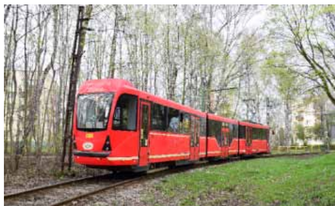
Фигура 17: Трамвай втора употреба от Франкфурт (DE) в Катовице (PL) с фирмените цветове на силезийските трамвайни пътеки, след цялостно обновяване и вграден нисък среден участък.
