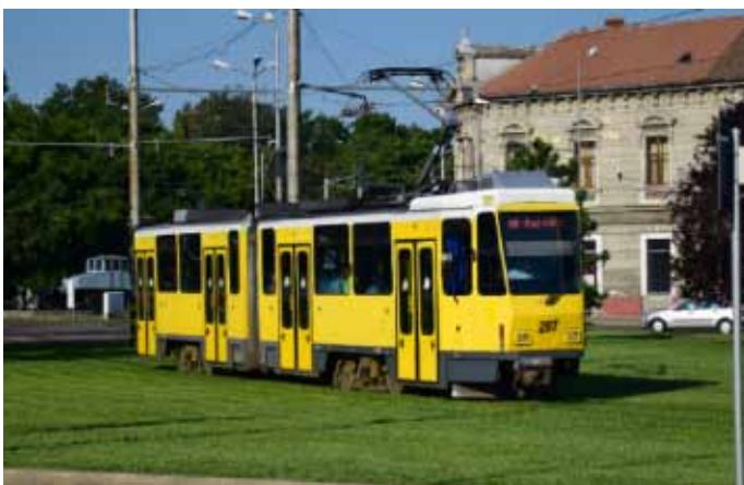
Фигура 11: Трамвайни коповози, покрити с трева в Oradea (RO), с берлински трамвай втора ръка като подобрение на качеството
